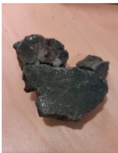
Oppmalt grønnstein - et restprodukt etter at silikomangan er tatt ut til bruk i stålindustrien, er silisiumrikt, og kan påvirke plantenes opptak av kadmium fra alunskiferen.
