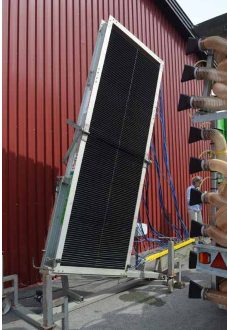
Vegg med renner for kontroll av væskefordeling, her i ferd med å tømme rennene over i måleglasa.
