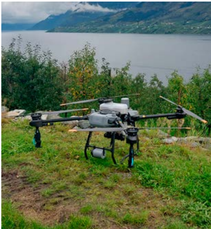
Drona: DJI T25 er utstyrt med to dyser og har ein væsketank på 20 liter. Det kan ettermonterast to ekstra dyser. / FOTO: Endre Bjotveit
