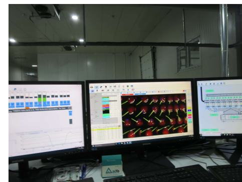
Optisk sortering – 4 kamera og 24 bilder per frukt (storleik, farge, ytre skader) NIR-sortering for indre skader
